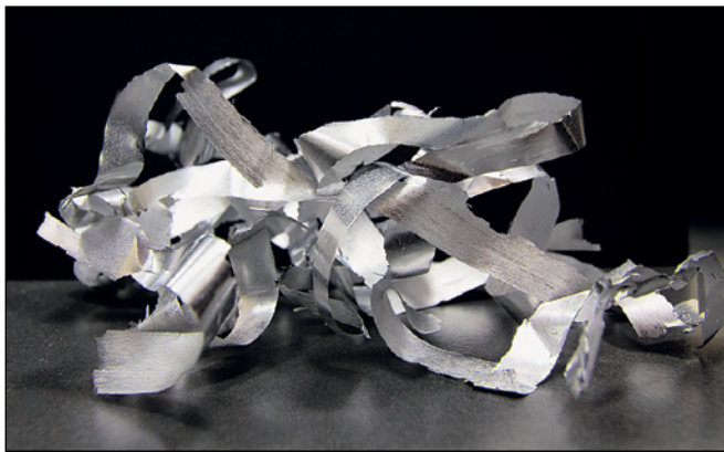
Алюминиевая лента с внедрёнными нанотрубками нитрида бора, полученная методом спиннингования.
