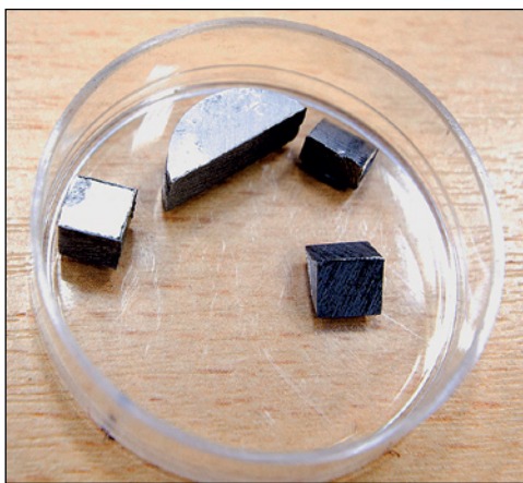
Композит на основе сплава алюминия с нанотрубками нитрида бора, полученный методом искрового плазменного спекания.
